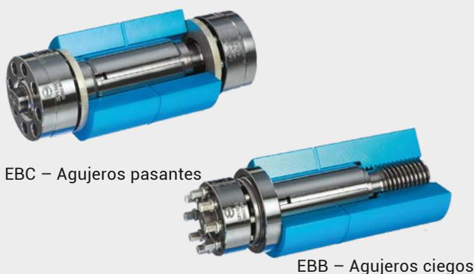
Los tornillos de expansión EzFit son tornillos de acoplamiento de expansión radial y tensión axial. Sustituyen los tornillos de ajuste forzado tradicionales, que son difíciles de instalar y desarmar, y garantizan la facilidad de instalación y desmontaje. Debido a la tensión radial, la unión experimenta un aumento de rigidez, eliminando así micro-movimientos en las bridas. Los EzFit son elementos totalmente mecánicos, fáciles de mantener y completamente reutilizables.
