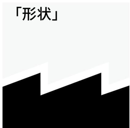
「形状によるセルフロック」の緩み止め方法は、振動や変動荷重がかかった時に、形状を利用しボルトの緩みを止めます。最も一般的なシステムであるウェッジロックワッシャーは、カム面が片側に、リブ面が反対側にある二枚一組のワッシャーで構成されています。リブ面の歯が被締結部及び締結部にグリップすることで、緩み方向の回転力がワッシャーとワッシャーの間で発生しますが、カムの形状上、ボルトの軸を伸ばしてカムを乗り越えることができないため、安全な締結部が構成されます。
