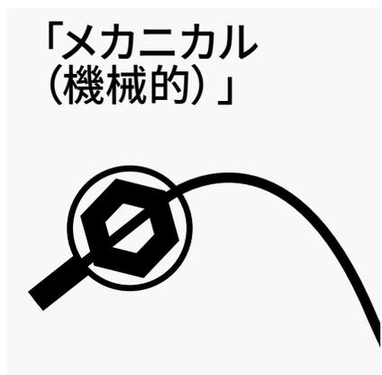
メカニカルロックは、締結部材の回転を防ぐために物理的な方法を用います。折り曲げ座金とロックワイヤーの二つの方法があります。折り曲げ座金は、座金の一端をナットの側面に当てるように折り曲げてナットが回らないようにする緩み止め方法になります。ロックワイヤーは、ボルト頭部・ナットの穴にワイヤーを通し、隣り合ったボルトナットに結び付ける緩み止め方法です。どちらも物理的に締結部材が緩み方向に回転するのを防ぐことができますが、変動荷重の条件下では、軸力の一部が時間の経過とともに失われる可能性があることに注意する必要があります。
